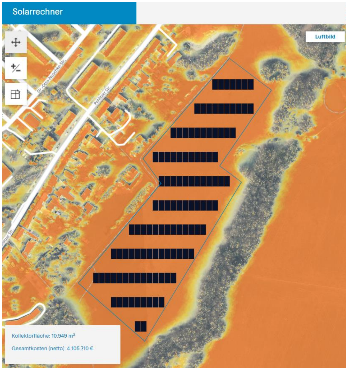
Abbildung 33: Screenshot Solarthermieanlage mit ca. 11.000 m 2 Bruttokollektorfläche
